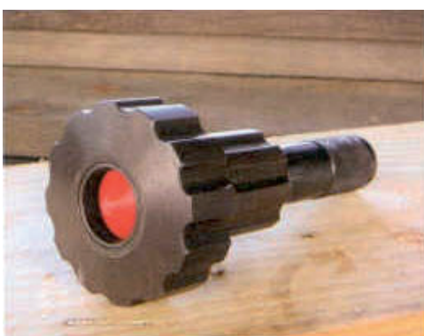
1 Lastometer zur Schnellprüfung der Narbenelastizität.
