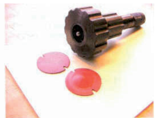
3 Lastometer mit Prüfingen, vor und nach der Prüfung.
